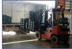
การเคลื่อนย้ายพาเลทBox Small Partจากตู้คอนเทนเนอร์โดยใช้รถโฟล์คลิฟท์
